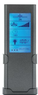
**FB-FNK-D LCD Touch:** Bedienung mittels Touch-Screen am Handsender der Fernbedienung. Schlaftimer (bis zu 12 Stunden) sowie eine 3-Minuten Abschaltautomatik für das Licht beim Verlassen des Raumes.
