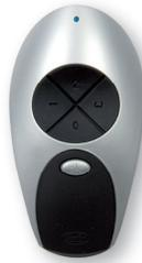
**FB-FNK Powerboat:** Universal-Fernbedienung für Nicht-ECO-Deckenventilatoren mit Design-Handsender. Funk-System im 434 MHz-Bereich, 16-fach codierbar, Reichweite ca. 10 Meter. Der Empfänger wird im Baldachin oder an der Deckenplatte (bei extraflachen Modellen) des Deckenventilators platziert. Der Handsender inkl. Wandhalter hat eine Betriebs-LED und wird mit einer Batterie vom Typ 23A, 12 V betrieben.
