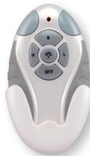
**FB-FNK Multicode:** Universal-Fernbedienung für alle Nicht-ECO-Deckenventilatoren. Funk-System im 434 MHz-Bereich. Der Empfänger wird im Baldachin oder an der Deckenplatte (bei extraflachen Modellen) des Deckenventilators platziert. Der Handsender wird mit einer Batterie vom Typ 23A, 12 V betrieben. Funktionen: Motor 3 Stufen/AUS, Licht dimmen, EIN/AUS. Motor max. 100 W, Licht max. 240 W. Wandhalter im Lieferumfang enthalten. Bis zu 65.000-fach codierbar.
