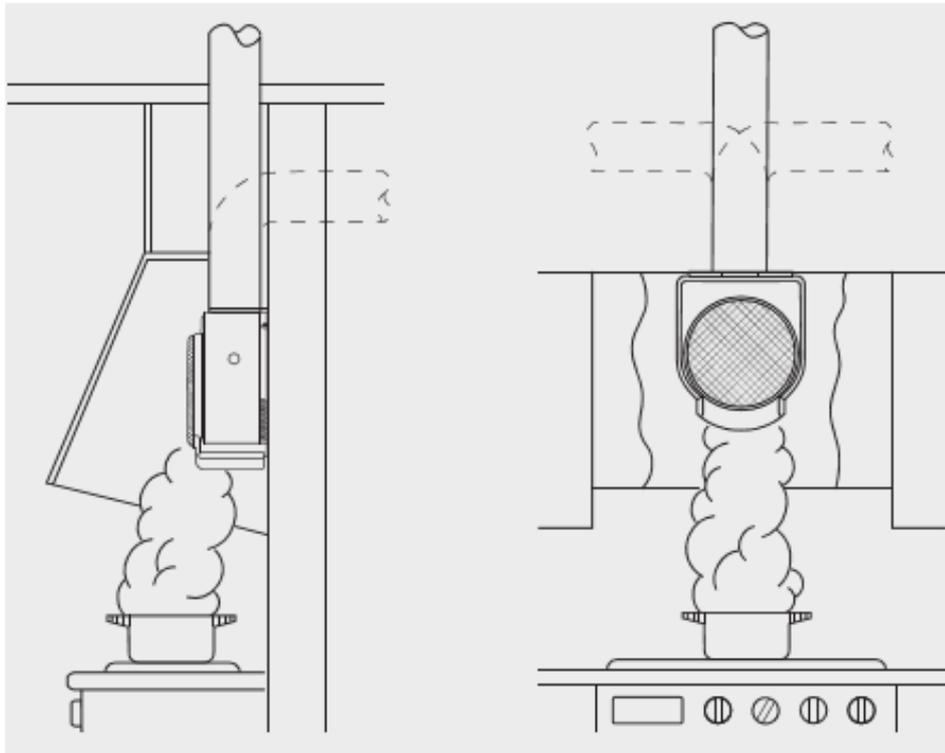
Um die maximale Effizienz der Absaugung zu erreichen, sollten die Ventilatoren der K-Serie in einer Herdhaube installiert werden. Der erforderliche Luftstrom hängt von der Haubenbreite und dem Abstand zwischen Haube und Kocher ab. Die Ventilatoren der K-Serie sollten in vertikaler Position mit der Fettauffangwanne nach unten installiert werden.
