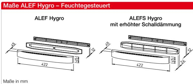
**Außenluft-Einströmelemente ALEF mit Volumenstromregelung/-Begrenzung, zum Einbau in Fensterrahmen-/Flügel.**
