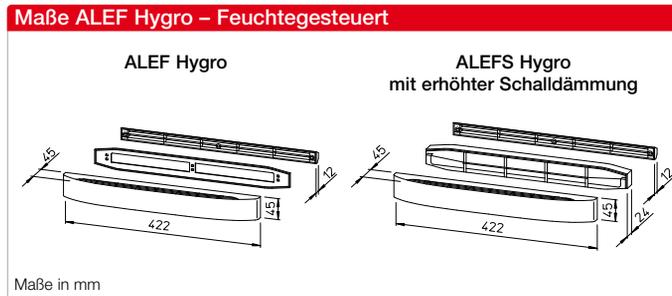
**Außenluft-Einströmelemente ALEF mit Volumenstromregelung/-Begrenzung, zum Einbau in Fensterrahmen-/Flügel.**
