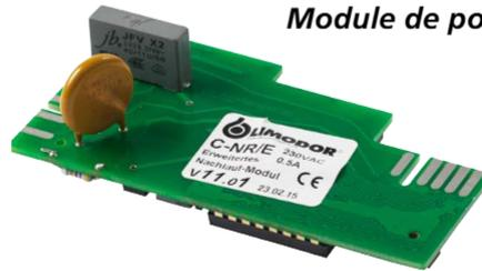
Das steckbare Nachlaufmodul C-NR/E ist für Lüftungsgeräte der Serie M geeignet und verfügt über einen weiteren Steckplatz für ein Zusatzmodul z. B. Feuchteregler C-FR3 (Zubehör). Durch die DIP-Schalter auf dem Steuermodul können verschiedene Einstellmöglichkeiten vorgenommen werden. Das Modul kann für die Funktion Nachlauf, zentrale Ansteuerung und Intervall verwendet werden.
