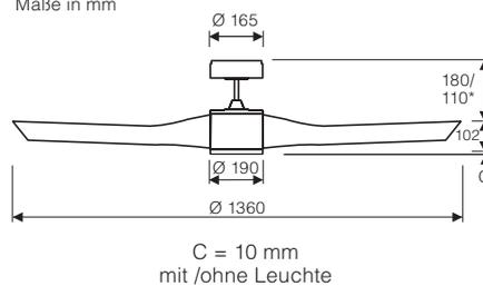
\*Maß mit beiliegender kurzer Deckenstange
