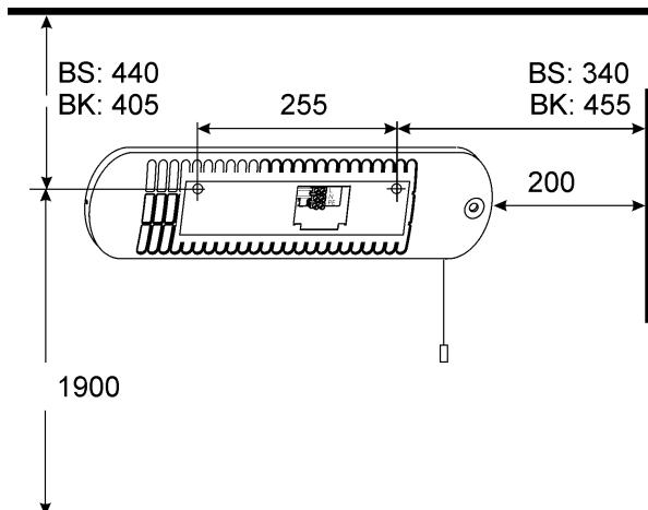
Het is niet toegestaan het toestel aan de zoldering of verticaal te bevestigen.
