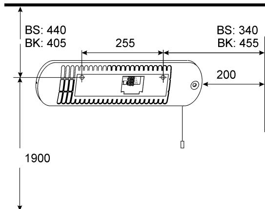
Un montage au plafond ou à la verticale est interdit.
