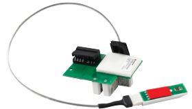
Le module d'humidité C-FR2 est une option enfilable pour tous les ventilateurs Limodor de la série M. Il permet de régler le ventilateur en fonction de l'humidité en combinaison avec le C-NR. Le montage du module est entrepris après dépose du module de puissance en le fixant tout simplement sur le C-NR.
