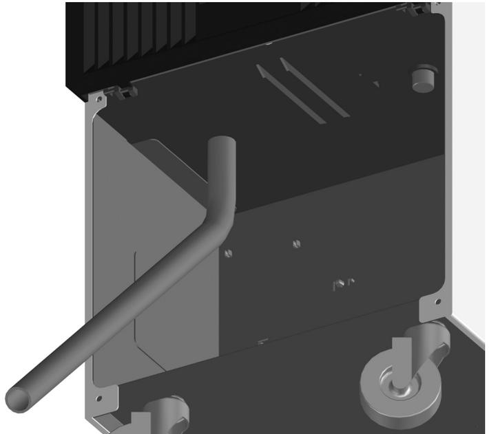
**ADVERTENCIA:** Verifique que el tubo no supere desniveles superiores a la altura del racor de descarga de la cubeta. Verifique también que el tubo no quede estrangulado, retorcido ni bloqueado.
