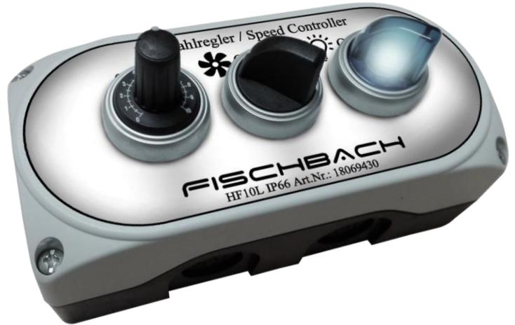
Das Fischbach Steuergerät HF10L IP66 mit Knebelwahlschalter 0-I und zusätzlichem Lichtschalter mit blauer LED Beleuchtung beinhaltet ein 10kOhm Potentiometer zur Ansteuerung von Geräten mit 10V-Ausgang oder 0-10 V-Steuereingang sowie einen zusätzlichen Schaltkontakt für Gasmagnetventile etc. Robustes, schlagfestes Aufputzgehäuse, Schutzart IP66 zur Verwendung in Industrie- und Küchenbereichen.
